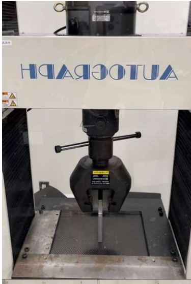
モノコックの強度試験の様子
