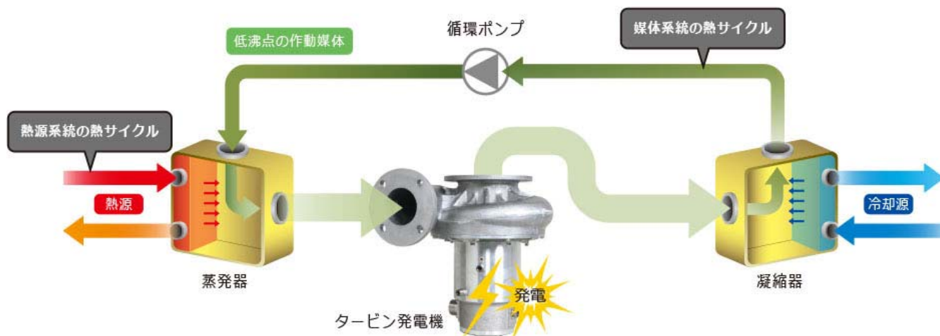
図2 バイナリー発電のしくみ[4]
