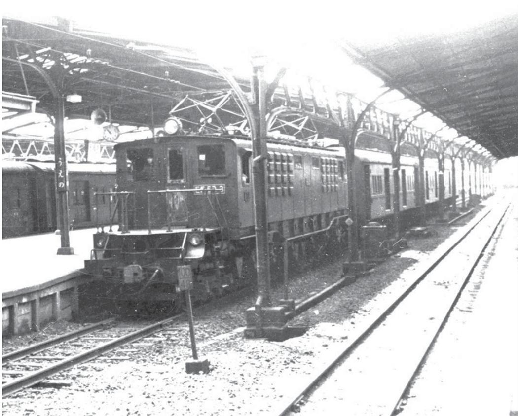
図 10 英国製 EF50 電気機関車（1956 年、上野）
