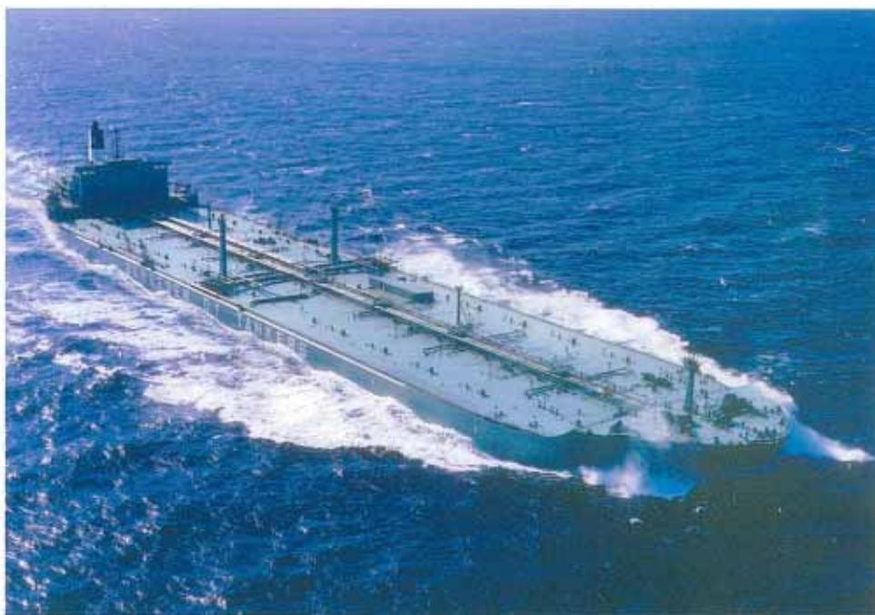
図 3.38 世界最大トルクの主減速装置の歯すじ荷重分布均一性の立証試験を満載・最大速度で実施中のウルトラ大形タンカー(第2船. 417000DWT)
