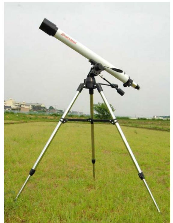
小学生などの入門用望遠鏡としては、口径6~8cmの屈折式・経緯台が妥当だと思います。経緯台は、(A)微動機構を持たないフリーストップ式、(B)微動付き、(C)両方を兼ねた方式の3種類があり、概ねこの順に価格が上がります。
