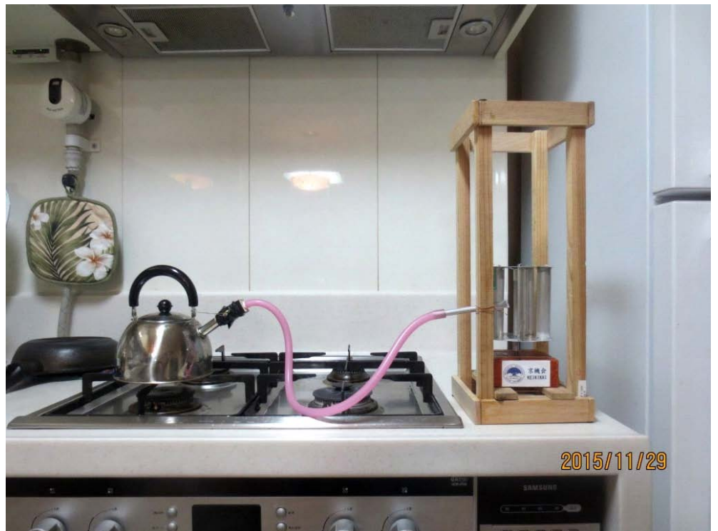
蒸気漏れが多く回らなかった「火力発電」
