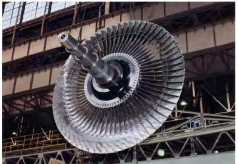
写真37 3,000rpm 48インチ翼
