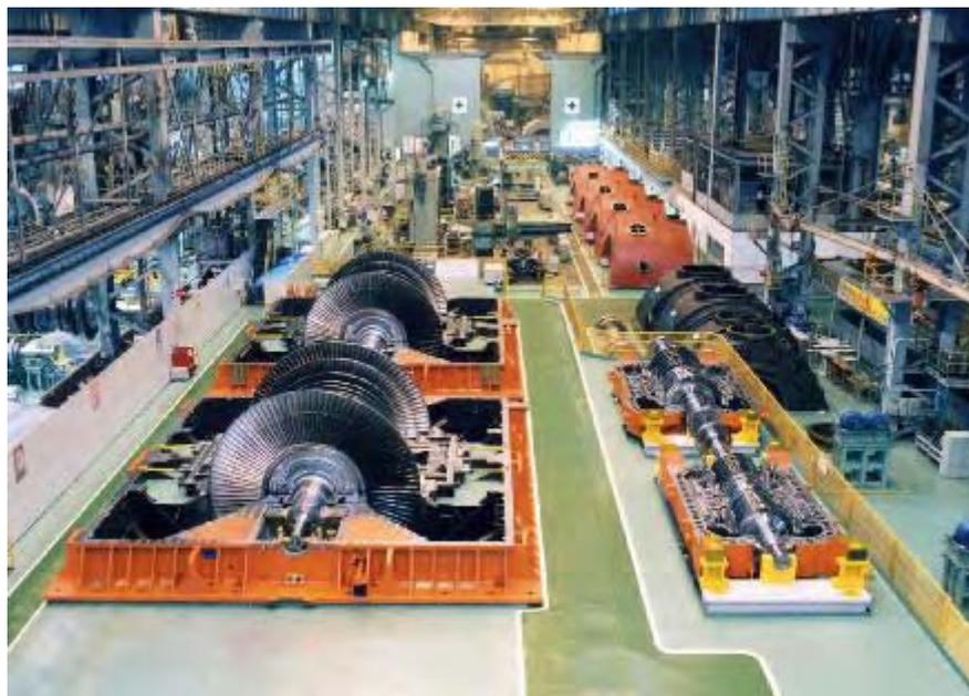
写真29 中国電力三隅1号1,000MWタービン工場組立
