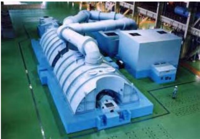
写真30 東北電力原町2号1,000MWタービン [提供] (株)日立製作所
