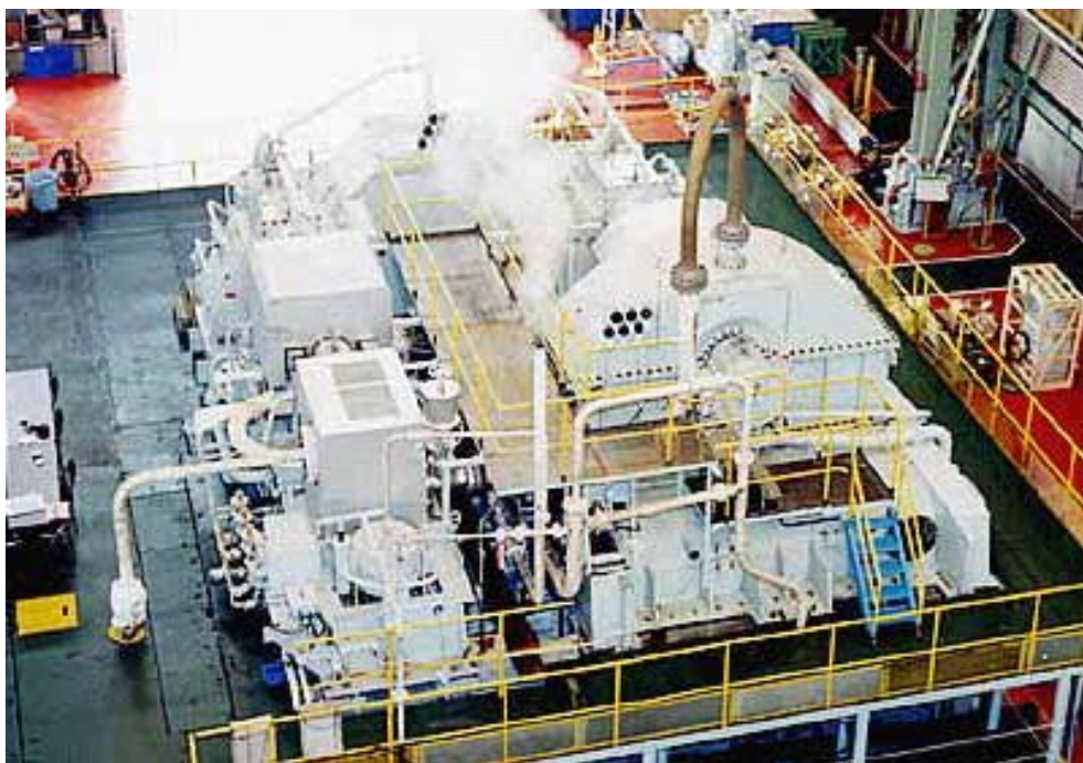
写真23 UA型船用主機タービン
