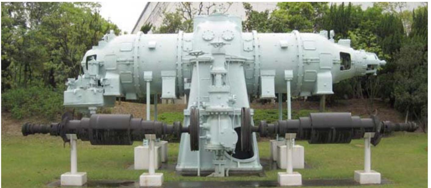
写真11 5,750kW ユングストローム背圧タービン
