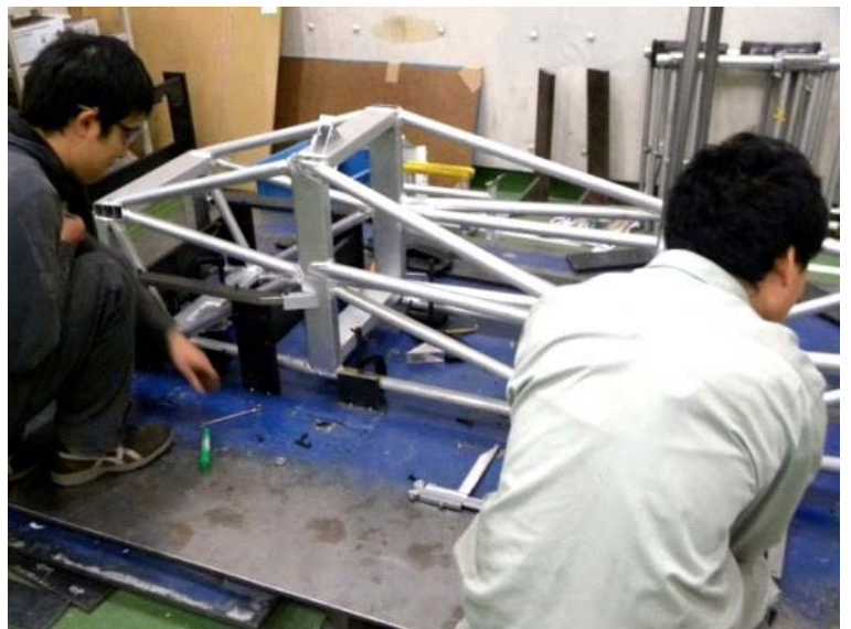
フレームに各種ブラケットを取付中
