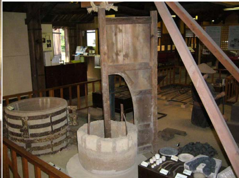
写真6 梵鐘の外型・中子・中子挽型
