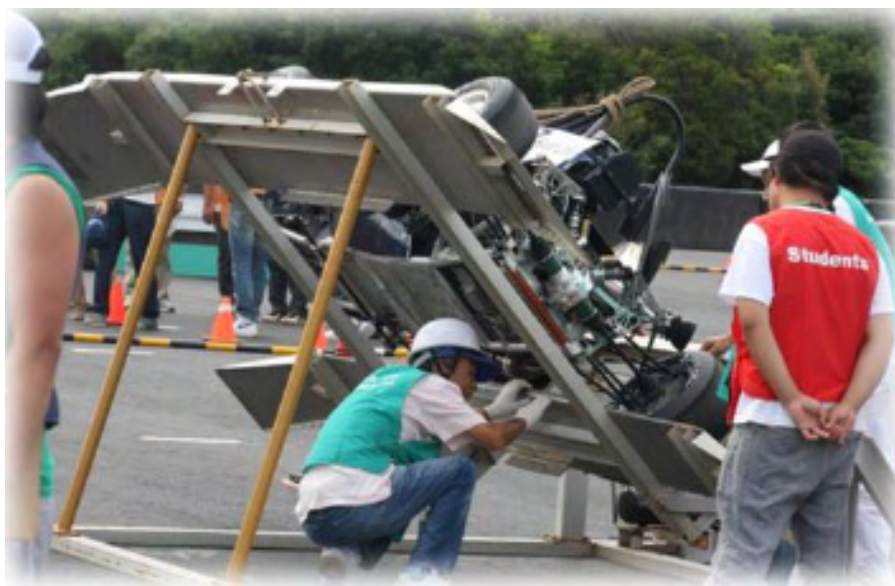
車両を60度傾け、液体類の漏れがないことをチェックするチルト試験
