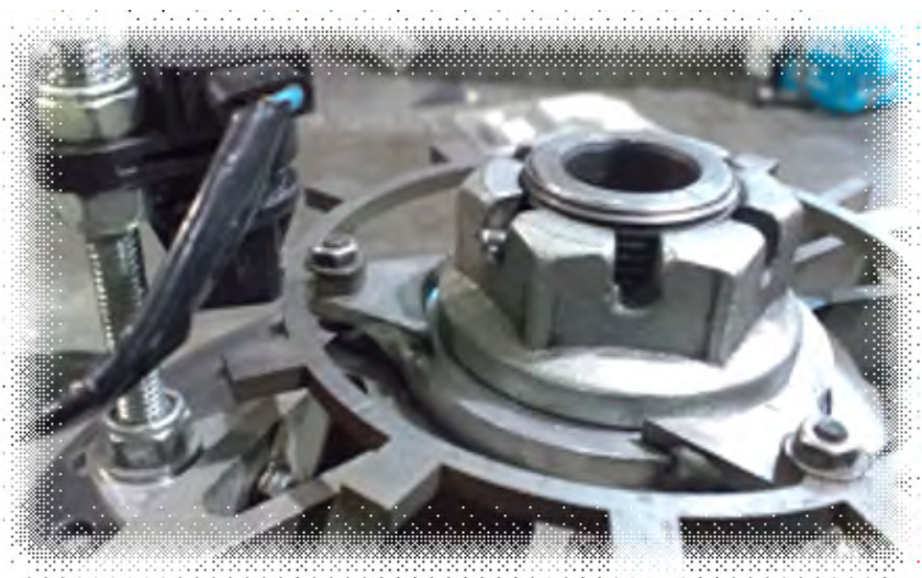
スピードセンサと検出ユニット。 前後の車輪速からスリップ率を計算し、 トラクションコントロールを行う
