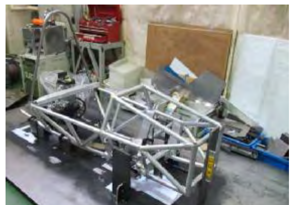
フレームはリア周り以外は完成し、エンジンの位置決めがなされた状態。
