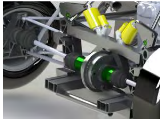
リアバルクヘッド周辺の3D CAD. アームやショックブラケット、ギアボックスマウントを兼ねる。
