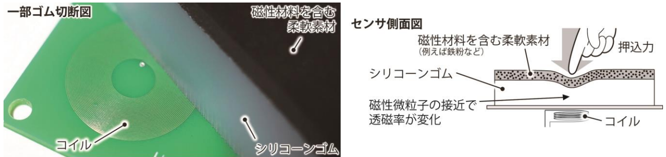
Fig. 1 磁性材料を用いた柔軟触覚センサ
