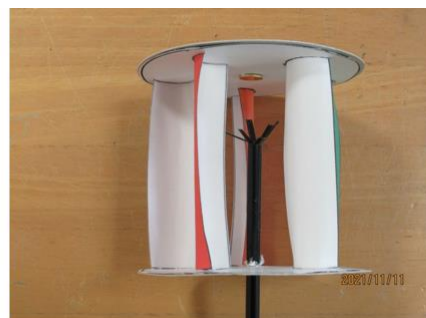
天板に押しピンを貼り付け、ストローを差し込み先端部を切り込んでセロテープで貼る
