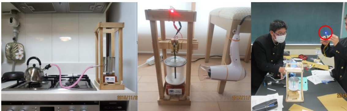
蒸気漏れが多くて圧力が立たず
