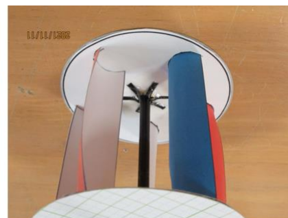
天板に押しピンを貼り付け、ストローを差し込み先端部を切り込んでセロテープで貼る
