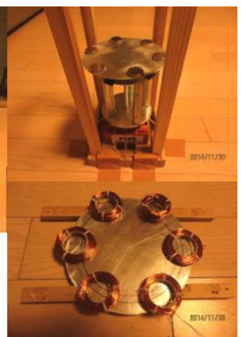
⑥ミニ風車駆動 交流発電機 4号機 コアレス発電機 無負荷電圧 2.4V 豆電球負荷時電圧 0.4V
