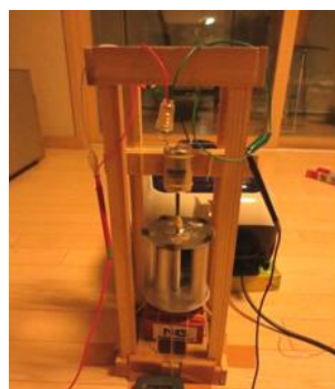
⑤ミニ風車駆動 直流発電機 2号機 掃除機の排気利用 0.88V 豆電球が微点灯
