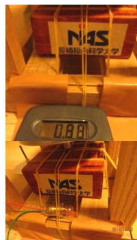
③ミニ風車駆動 直流発電機 2号機 大形マブチモーター
