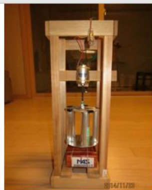
③ミニ風車駆動 直流発電機 2号機 大形マブチモーター
