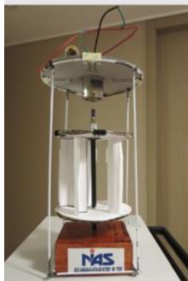
②ミニ風車駆動 直流発電機 1号機
