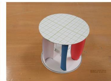
翼端部をセロテープで貼り付け、両面テープで端板を貼り付ける
