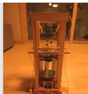
⑥ミニ風車駆動 交流発電機 4号機 コアレス発電機 無負荷電圧 2.4V 豆電球負荷時電圧 0.4V
