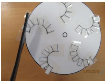
翼端部をセロテープで貼り付け、両面テープで端板を貼り付ける
