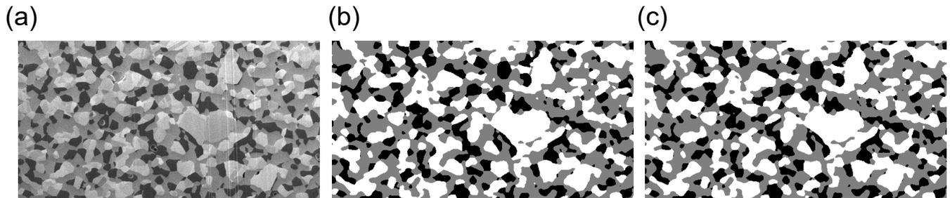
図3 Semantic segmentationを用いたFIB-SEM画像の領域分け。(a) 元の電子顕微鏡画像（グレースケール）、(b) 手作業を含む従来手法による領域分け画像、(c) semantic segmentationによる領域分け画像。白：金属Ni相、灰色：電解質YSZ相、黒：空隙相（樹脂で包埋）。
