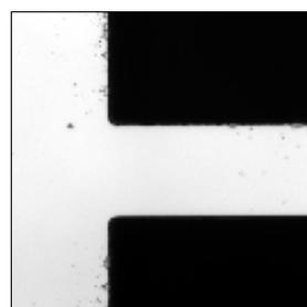
金製の電極から延伸する極細配線
