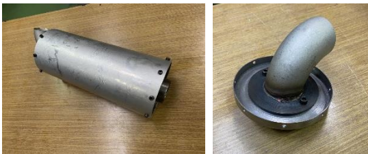
製作したマフラー パイプ・フランジ部分
