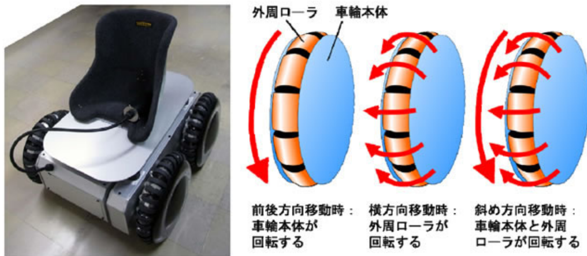
図4 全方向移動装置パーモビー（Permover）と全方向駆動車輪
