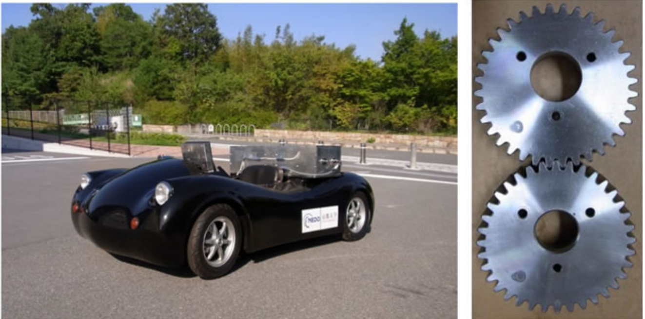
図2 開発した変速システムを搭載した 小型電気自動車エビュート(EVUT)と非円形歯車
