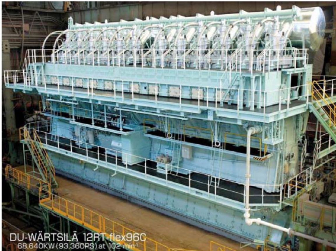
当時世界最大級のコンテナ船の主推進原動機として採用されたディーゼルエンジン 12筒 980mmボア／2500mmストローク 最大出力93,000PS (69,000kW) 重量2,000 ton (35kW／ton) (日本シッパード、旧 IHI Marine United)
