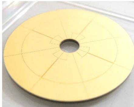
[図3](#) ニオブ酸リチウム単結晶を用いた圧電ディスク型ジャイロスコープ
