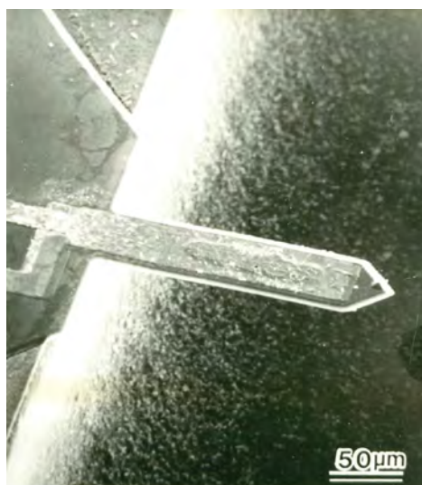
図1 圧電薄膜自己検出型微小力センサ
