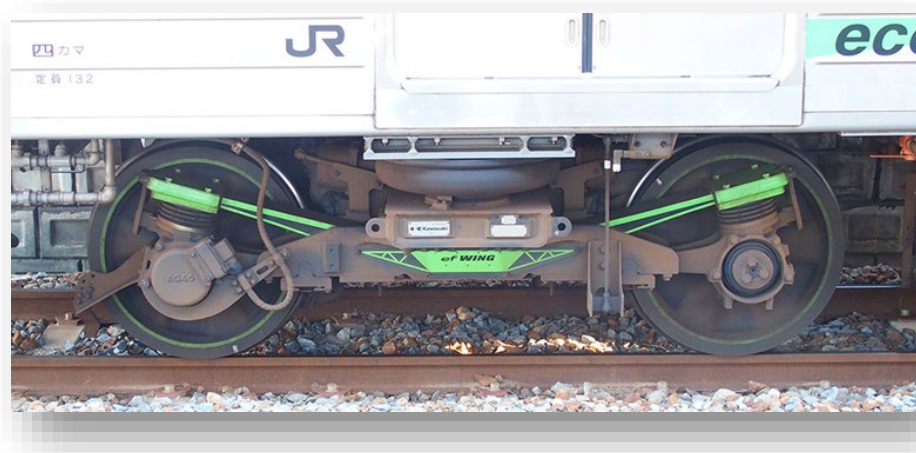
図3. JR四国7200系に用いられている台車（efWING, 川崎重工製）
