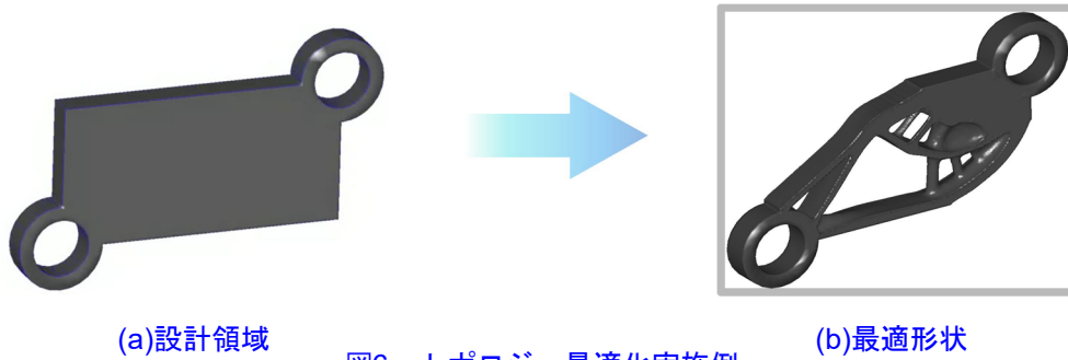
図6 トポロジー最適化実施例
