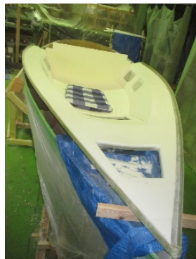
上部デッキFRP積層
