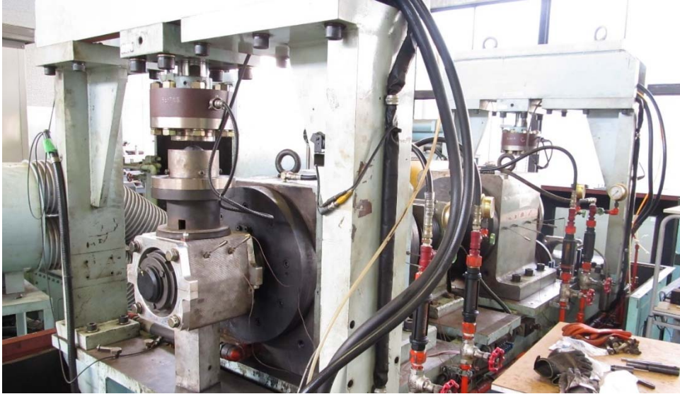
鉄道車両用車軸軸受の耐久試験機
