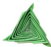
図8 等角螺旋を用いた円形膜の巻取り線図および折紙モデル
