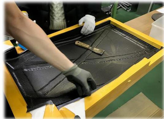
CFRP 製エアロパーツ脱型の様子
