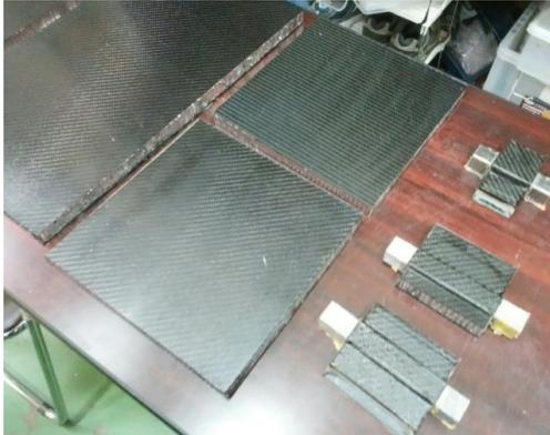
モノコック強度測定用の試験片
