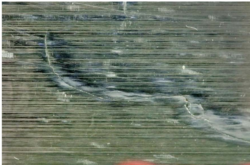
図9 稼働2年後に、偏析に沿って発生した大形歯車歯面の亀裂
