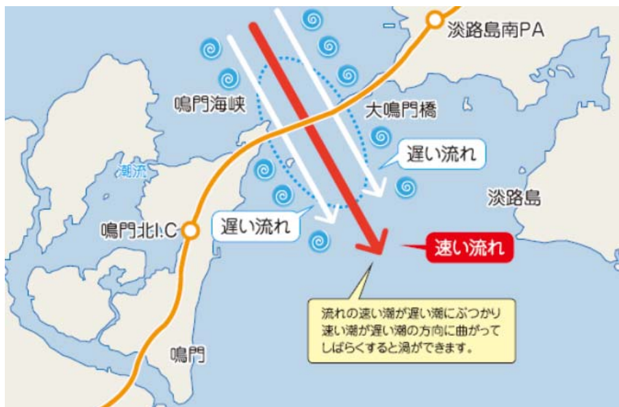
図1 渦潮が発生する仕組み
