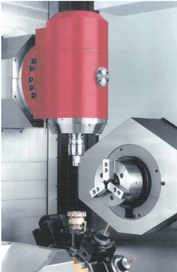
ミリング主軸と八角断面ラム
