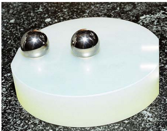
40 nm より良好な形状・寸法精度を達成したインボリュート検査装置校正検定用アーティファクト (ボール直径 1インチ)
