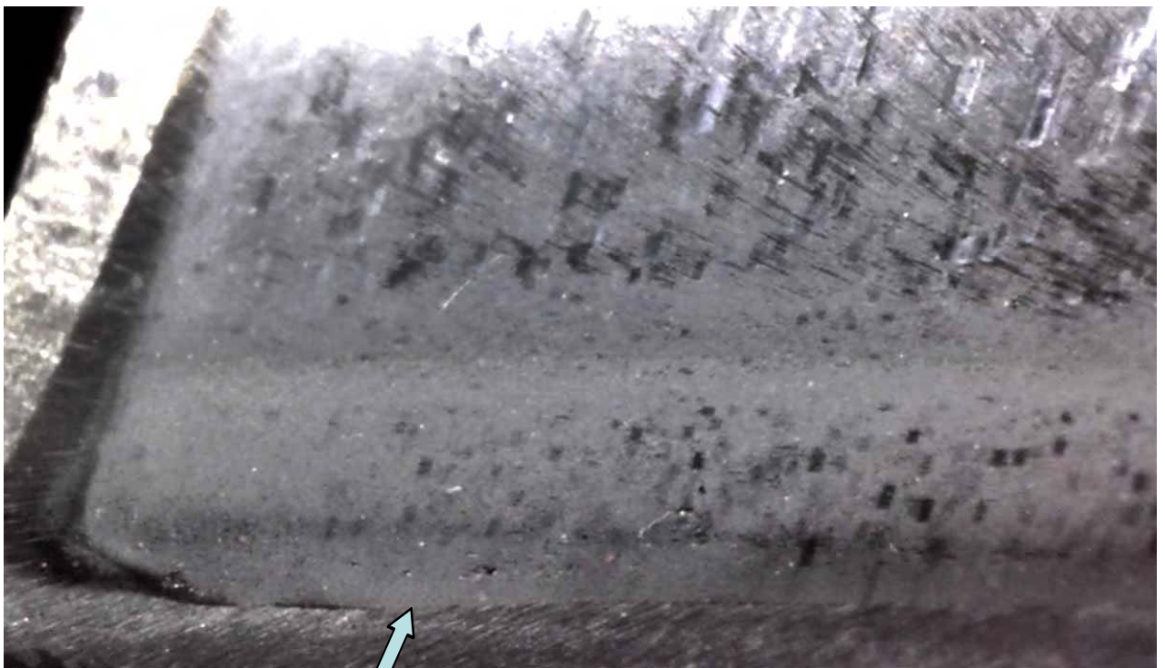
この辺りが接触し出す時に回転遅れが最大になる
