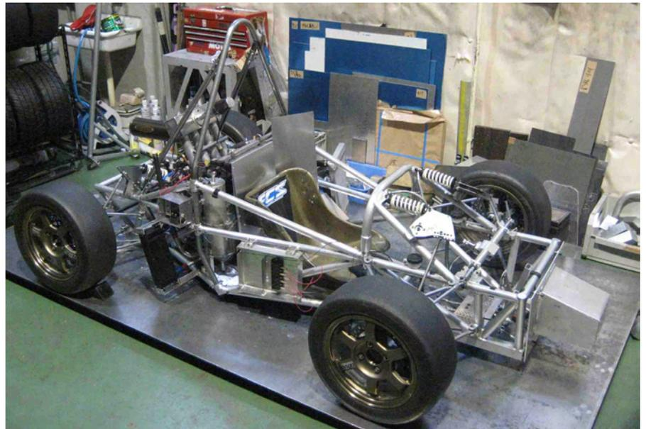
2月下旬には燃料タンク、オイルタンクが搭載され、続いて冷却系のラインが取り付けられました。燃料、冷却、潤滑の各ラインが組みあがった後は吸気取り付けられ、ドライバーを熱や万一の火災事故から守るファイヤーウォールの製作が行われました。一方足周りでは、ブレーキユニットが搭載され、ブレーキラインが完成しました。ステアリング、シフトも順調に作業を進めています。また、ドライバーが走行時にマシンの状態を確認するためのインパネや、それに伴う電装部品の製作も大詰めを迎えています。
